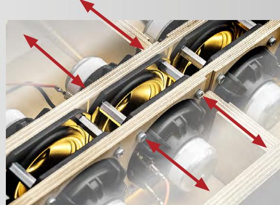
Благодаря встречному расположению динамиков и усиленной конструкции вибрации корпуса сведены к минимуму. Поэтому нет необходимости в разъединении «сухого» строительства или мебели, что упрощает бесшовное встраивание. Два отделенных друг от друга канала позволяют
